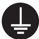
アース線の接続 Connection of grounding conductor
